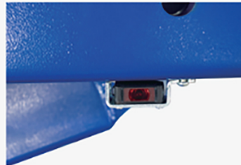
Devrilmeyi önlemek için fotoelektrik anahtar
